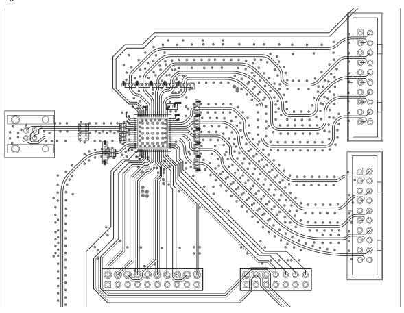
Figure 10-2. DS90UB948-Q1 Deserializer Example Layout
